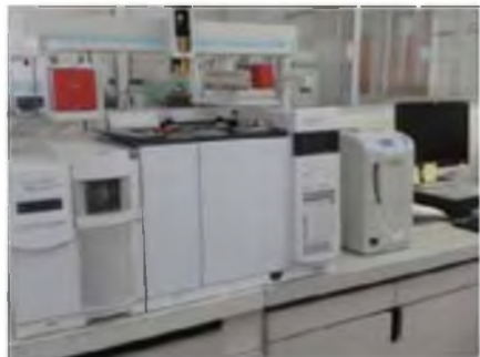
Foto 10. Cromatógrafo de gases (GC). Agilent 7890 Series
