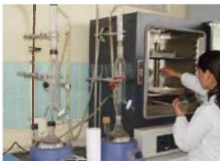
Foto 3. Secado de muestras de cacao en estufa
