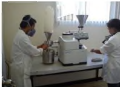
Foto 2. Molienda de muestras utilizando equipo RETCH ZM-200
